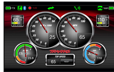
El tablero de instrumentos personalizado de Traxxas Link proporciona datos del rpm, la temperatura y el voltaje en tiempo real.
